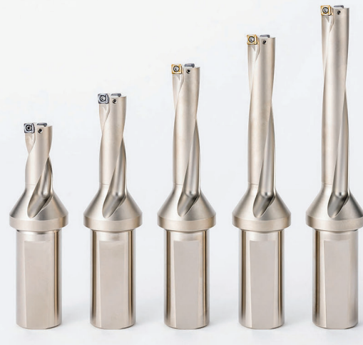
3 Die robusten Hochleistungs-Wendeplattenbohrer MagicDrill DRV erzeugen bis 60 mm Durchmesser Bohrungen bis 6 \times D Tiefe mit hoher Qualität. Späne werden effektiv abgeführt (© Kyocera)
